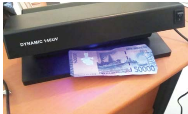
Gambar 30. Ultraviolet mendeteksi keaslian uang
